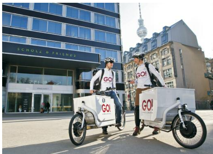
E-Lastenfahräder vom Kurierdienst Go mit 100 kg Zuladung, bis zu 250 km Reichweite mit 25 km/h Geschwindigkeit
