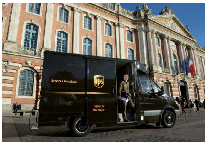
Elektrozustellfahrzeug P45E in Toulouse: Auf Basis eines Sprinters lässt UPS Diesel- in Elektrofahrzeuge umrüsten
